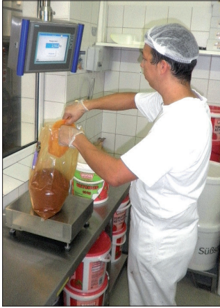
Vorbereitung einer Gewürzmischung am Handverwiegeplatz
