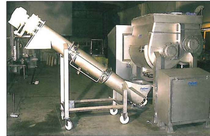
Die gegenläufige Doppeltroch-Austragschnecke des DZK 1000 ist auf Laufrollen aufgesetzt und kann zur Reinigung aus der Anlage herausgeschoben werden
