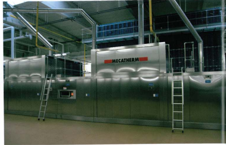
Links: In einem separaten, klimatisierten Raum wird Feingebäck mittels einer Fritschlinie hergestellt. Rechts: Der MecaTherm-Tunnelofen mit dem neuen Paternoster-System im Hintergrund.
