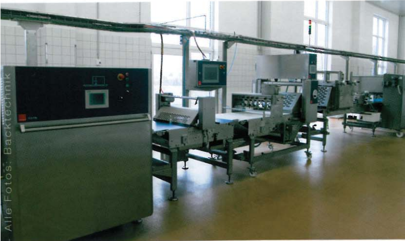
Links: In einem separaten, klimatisierten Raum wird Feingebäck mittels einer Fritschlinie hergestellt. Rechts: Der MecaTherm-Tunnelofen mit dem neuen Paternoster-System im Hintergrund.
