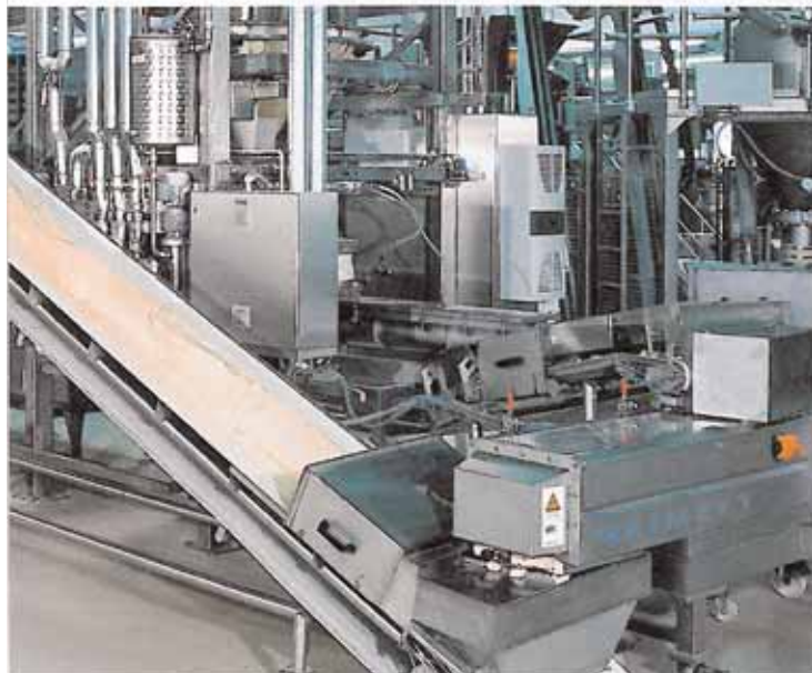
Kompakt gebaut: Codos-System für eine Weizenteiganwendung, im Vordergrund befindet sich die Übergabe des fertigen Teiges aus dem Codos-Kneter auf ein Transportband
