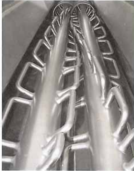
Die Bügelwerkzeuge des Codos-Knetters CK tragen die zur Entwicklung eines optimalen Klebergerüsts erforderliche Energie ein
