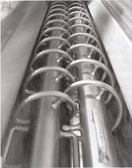
Die Wendeln des Codos-Mischers CBH sorgen für eine gründliche und schonende Durchmischung der Teigzutaten
