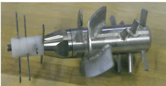
Das Mehl wird durch den Spalt in der Mitte des Zylinders mit einem Feuchtigkeitsfilm benetzt und anschließend von Stiften vermischt.
