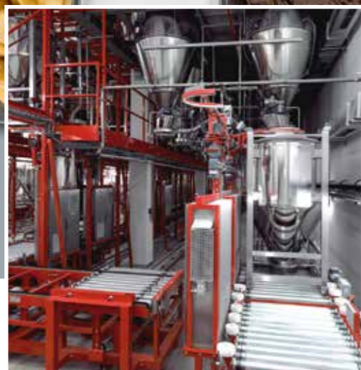
Наполнение контейнера с помощью KAD — KOKEISL
